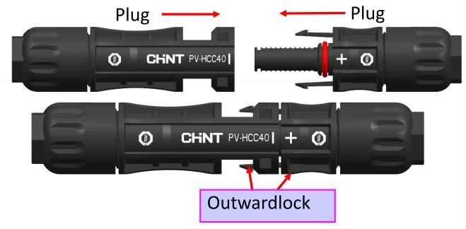
**8.**把专用工具/PV-HCC40专用工具插入连接器扣位处往后推,同时正负连接器往相反方向拉就可打开连接器。
