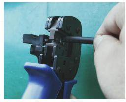
**4.**松开压线钳手柄取出线缆,目视检查端子是否有未压牢固、压偏、漏铜丝等现象.
